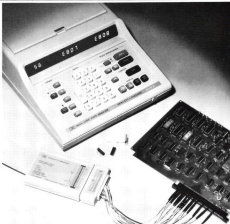
Twee stukjes geschiedenis van de logica-analysator. De bovenste foto toont de HP1602A, een zelfstandig werkende status-analysator met een LED-display dat één regel informatie kon weergeven. Het onderste instrument, de 1610A, was eveneens geschikt voor status-analyse, maar beschikte evenwel door het grote beeldscherm over uitgebreidere weergeefmogelijkheden. Geheugenspecificaties: 32 x 64 bit.
