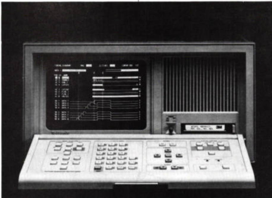
Tektronix' digitaal analysesysteem DAS 9100 is een uitgebreid modulair instrument dat een meetobject niet alleen passief maar door ook actief kan analyseren door het aanbrengen van een 25 MHz-patroongenerator-module (vectorbreedte tot 80 bit) en het meten van de responsie. Het kanalschema omvat maximaal 104 kanalen, die naar keuze alle voor timing- dan wel voor status-analyse kunnen dienen. Bij toepassing van actieve analyse kan het instrument maximaal 80 generatorkanalen en 96 acquisitiekkanalen bevatten. Voor een duidelijke presentatie van een grote hoeveelheid parameters ontwikkelde de fabrikant ook een versie met kleurenbeeldscherm.
