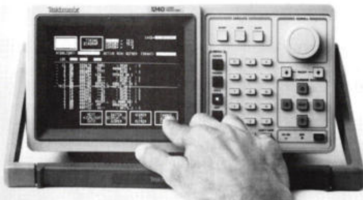
Een „scroll“-knop en een beeldscherm met aanraakgevoelige sectoren behoren tot het bedieningsconcept dat Tektronix ontwikkelde voor de 1240.
